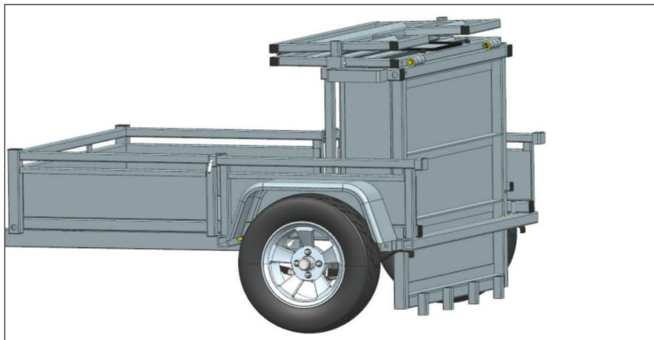
Figure 6: Logement des goupilles de blocage pour la position fermée
