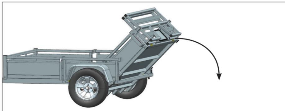
Figure 19: Remorque déployée, goupilles de blocage en place
